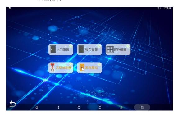
安全控制,主要有大門磁簧、後門磁簧、窗戶磁簧、瓦斯偵測器,以及緊急壓扣接點(需搭配保全模組)
