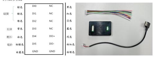
保全模組(選配)的接線示意圖如上,分別是 DIO 到 DI5 的設定。其中 DIO、DI1、DI2 是監控磁簧開關,DI3 是瓦斯偵測,DI4 是緊急壓扣,DI5 是電鈴功能,當門口電鈴按下時,CP-10 會發出電鈴聲。其中在系統設定、安全設定、以及 DI 狀態設定中,可設定 DI 的類型是 NC 或是 NO,預設值則為 NO。完成後,按返回鍵 可回到主畫面。
