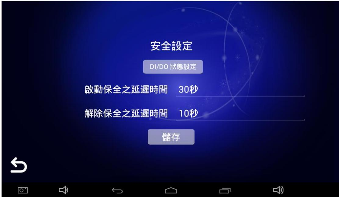
DI 狀態設定: CP-10 社區版中, 可監控共計 6 個 DI 及 2 個 DO, 如以下示意圖. 其中 DI0, DI1, DI2 是監控磁簧開關, DI3 是瓦斯偵測器, DI4 是緊急壓扣. DI5 可外接門鈴, DO0 可外接保全狀態燈, DO1 可外接警報狀態燈.
