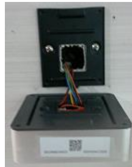
圖二 用一個不含屋簷的壁板壁掛在牆面
